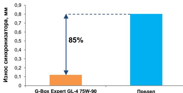
G-Box Expert GL-4 75W-90 защищает синхронизаторы из цветных металлов от износа, сохраняя комфорт работы оператора техники даже при частых переключениях передач
