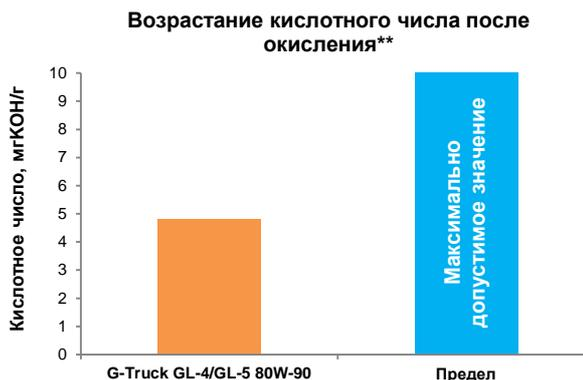
G-Truck GL-4/GL-5 80W-90 стабильно к окислению и минимизирует образование кислот. Возможность увеличения интервала замены.
