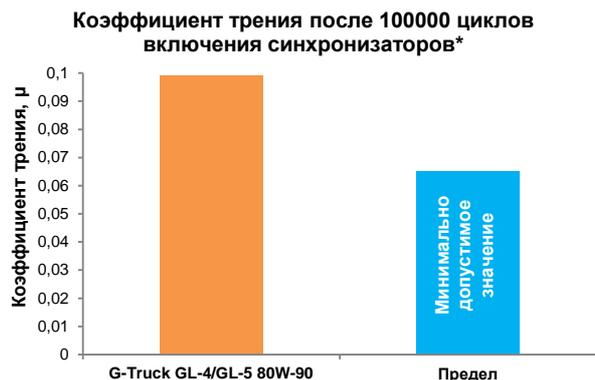
G-Truck GL-4/GL-5 80W-90 поддерживает высокий коэффициент трения на всем сроке службы, обеспечивая плавное переключение передач.
